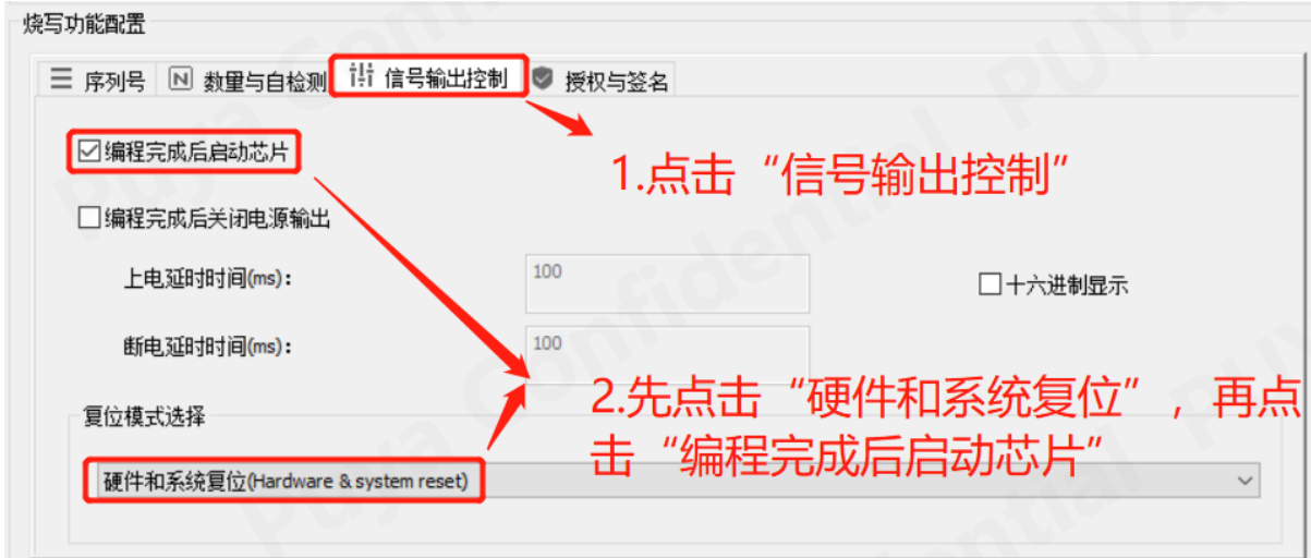
图 6-3 创芯工坊操作勾选“编程后重启芯片”
